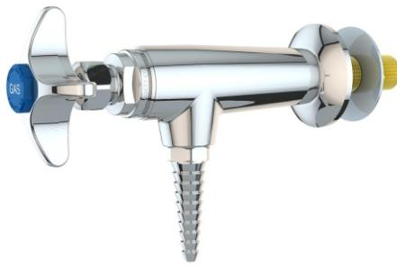
**Montaje:** para la instalación en superficies verticales (como canales de tuberías y portadores de servicio) donde hay acceso detrás de la superficie durante la instalación. El vástago de montaje roscado se inserta a través del orificio en la superficie y se asegura con una contratuerca y una arandela.
