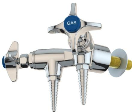
**Aplicación:** Regulación del flujo de todos los gases de laboratorio, incluidos gases especiales como nitrógeno, oxígeno, helio e hidrógeno. Cuando se ordena, la válvula se puede limpiar, lubricar y empaquetar especialmente para servicio con gas puro. Válvula certificada para el servicio de gas natural por CSA International.
