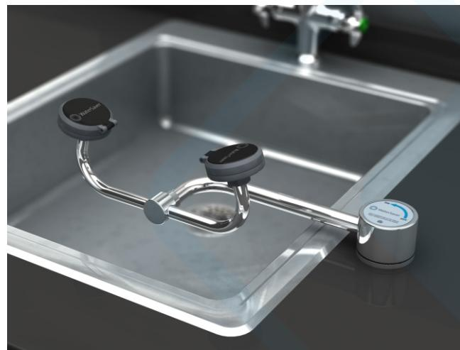
Aplicación: AutoFlow™ lavado de ojos / cara para montaje en mostrador al lado del fregadero. Al girar el conjunto del cabezal rociador 90 grados horizontalmente sobre el fregadero se activa el flujo de agua. La unidad permanece en funcionamiento hasta que el conjunto del cabezal rociador vuelva a la posición de almacenamiento y cierre la válvula.
